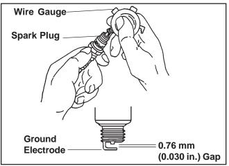
Figure 24. Servicing Spark Plug.
